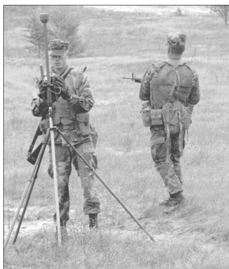
Рис. 8. Наиболее эффективный путь точной привязки артиллерийских позиций с помощью приемников системы GPS
