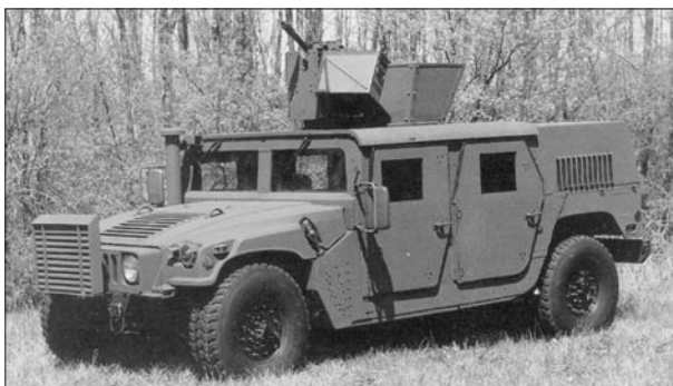
Бронированный автомобиль М-1116, разработанный в соответствии с требованиями ВВС США (на нем установлен 40-мм гранатомет)
